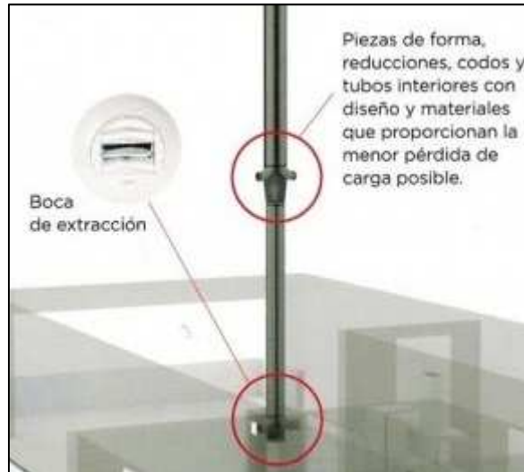
Boca de extracción
