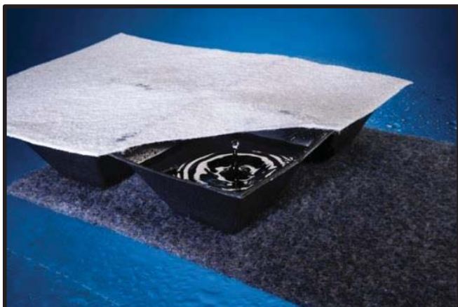
Figura 45: ( www.lindumgreenroofs.co.uk ) Fotografia que mostra el funcionament de la capa drenant i filtrant. El drenatge emmagatzema l'aigua filtrada provinent del substrat. L'aigua que excedent del drenatge acaba en la manta retenidora de baix.
