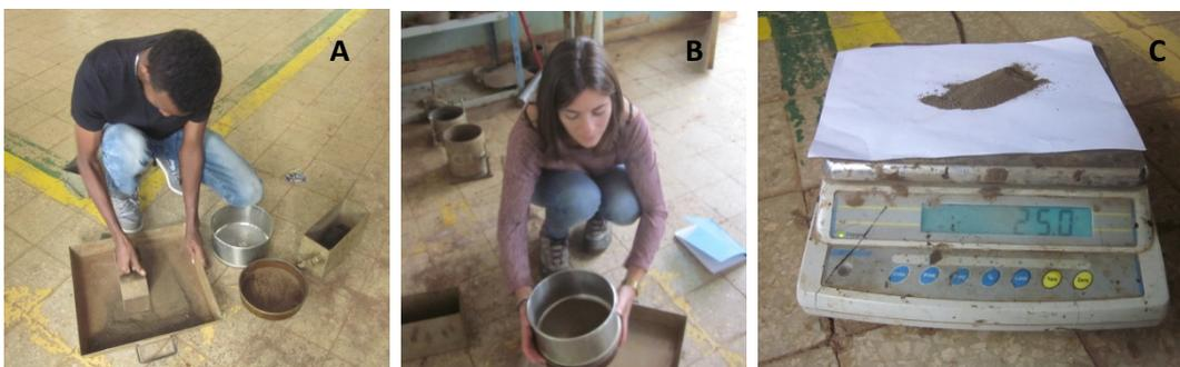
Figura 5. A) Afework Limenh disgregando la muestra. B) Inés Torán tamizando la muestra. C) Muestra pesada en la báscula
