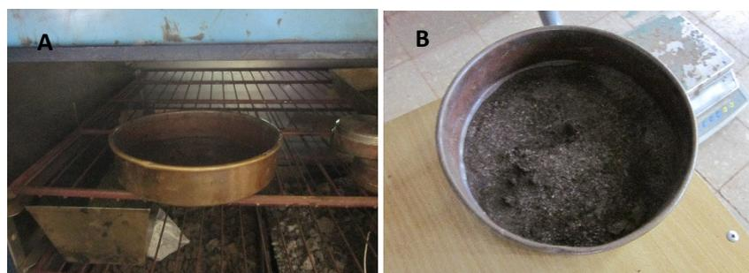
Figura 15. A) Muestra húmeda en el horno. B) Muestra seca tras 12 h
