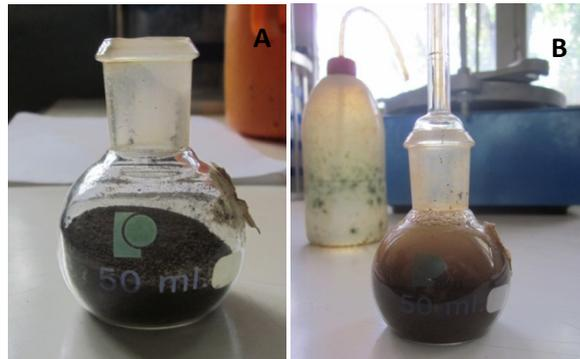
Figura 6. A) Picnómetro con 25 gr de muestra. B) Picnómetro con la muestra y el agua.
