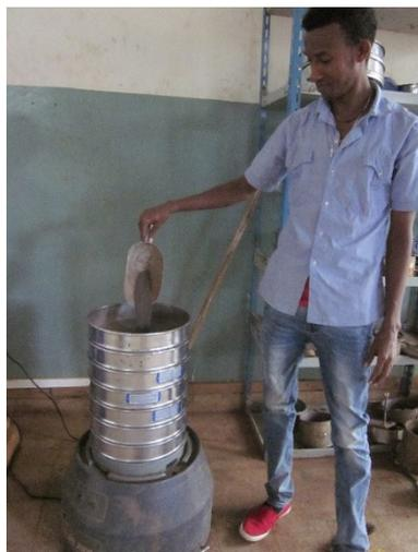
Figura 16. Afework Limenh colocando la muestra de suelo sobre la torre de tamices. Bajo los tamices se encuentra el agitador.
