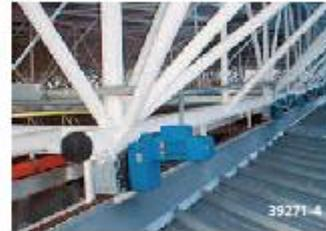
La corona dentada de la parte frontal de la tapa de la carcasa de nuestros reductores planos permite, junto con el antimomentos correspondiente, fijar el accionamiento en diferentes posiciones al bloque de rueda DRS: en pasos de 15 °, para encontrar la posición más adecuada del accionamiento para el conjunto de la instalación.
