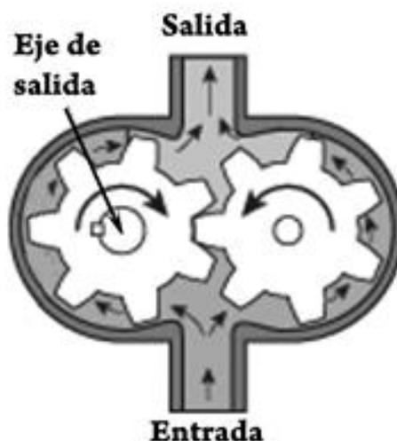
Imagen 3. Funcionamiento motor hidráulico de engranajes.
