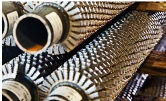
*Ilustración 40 - Disposición de las aletas en el tubo interior del intercambiador*
