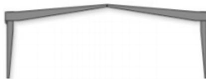
*Ilustración 2: Pórtico de perfil variable.*
