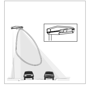
Lámpara en posición adelantada para una reducida anchura de la calzada (L=0,8 H).
