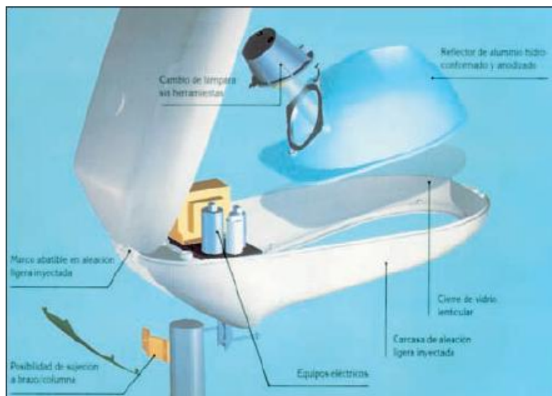
Ilustración 17. Elementos de una luminaria
