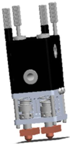
Figura 76: Cabezal de impresión en detalle
