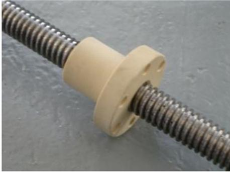
Figura 35: Tornillo de potencia
