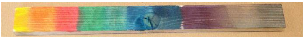
Ilustración 2.37: Tintado de la madera con anilina
