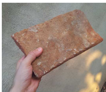
Imagen 62: Ladrillo macizo 27x15x4 cm empleado para sistemas de compartimentación
