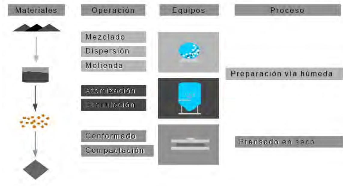
Figura 2. Proceso de fabricación de baldosas cerámicas
