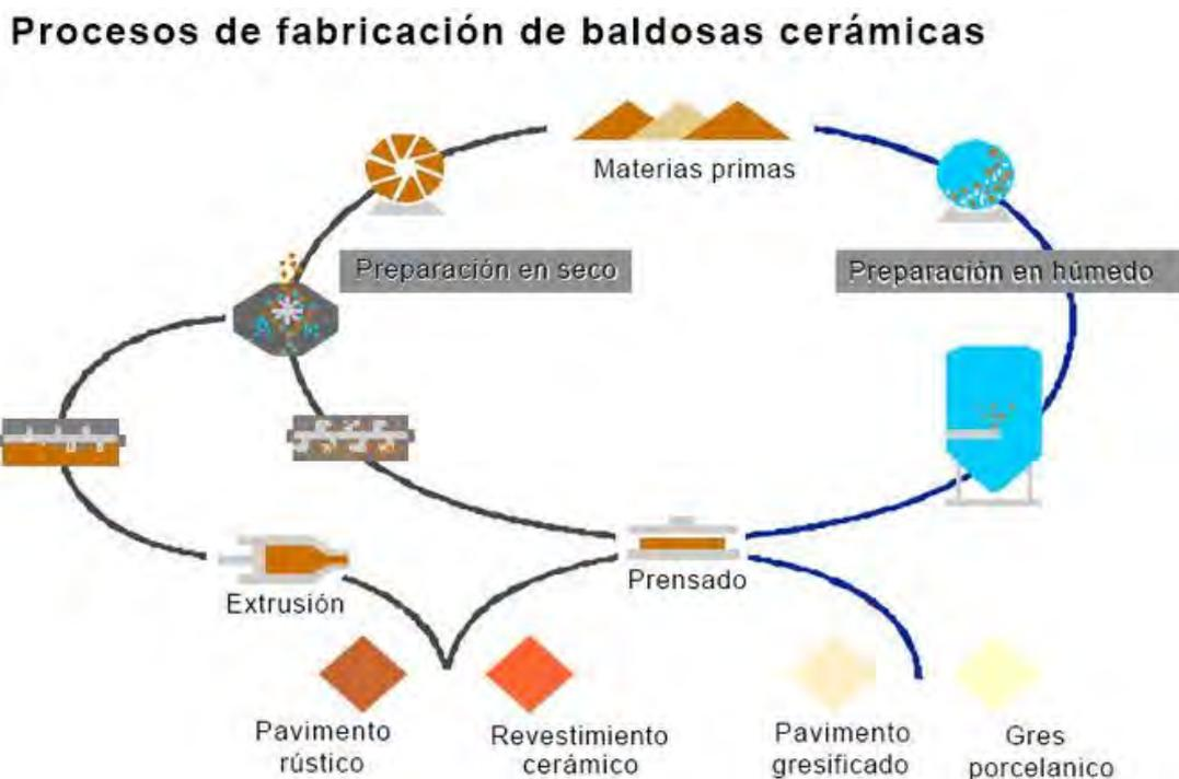
**Figura 1. Diagrama de los procesos de fabricación considerados**
