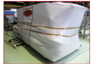
Plastificación de equipos
