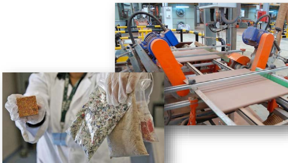
Imagen 9: Proceso fabricación baldosa cerámica de materiales reciclados
