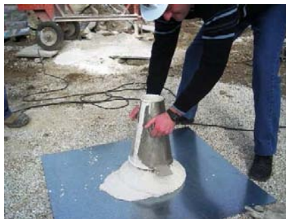
Ilustración 68 Realización del ensayo del cono de Abrahams para comprobar la fluidez del hormigón; Fuente: argosdc.com
