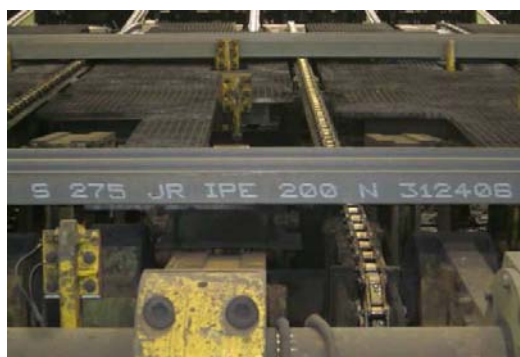
Ilustración 69 Marcado de perfil IPE200 en taller para su fácil identificación posterior; Fuente: marcado-grabado.es
