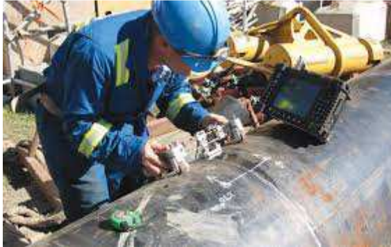
Ilustración 70 Comprobación mediante ultrasonidos de soldadura; Fuente: metalactual.com
