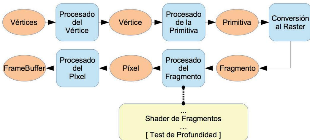
Figura 4.9: En color amarillo, las tareas principales que se realizan en la etapa correspondiente al procesamiento del fragmento donde se indica que el test de profundidad se realiza con posterioridad a la ejecución del *shader* de fragmentos
