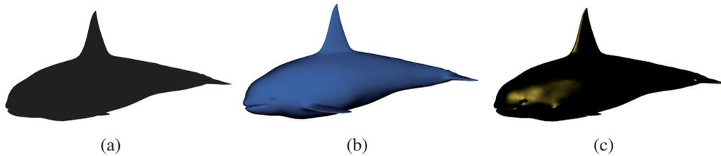
Figura 5.2: Ejemplo de las componentes del modelo de iluminación de Phong: (a) Luz ambiente; (b) Reflexión difusa; (c) Reflexión especular. La combinación de estos tres aspectos produce el resultado que se muestra en la figura 5.1
