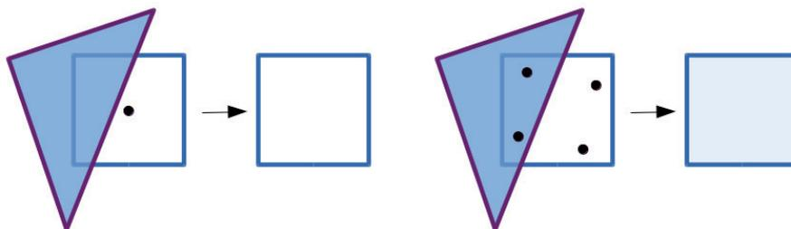
Figura 10.3: Ejemplo de funcionamiento del *supersampling*
