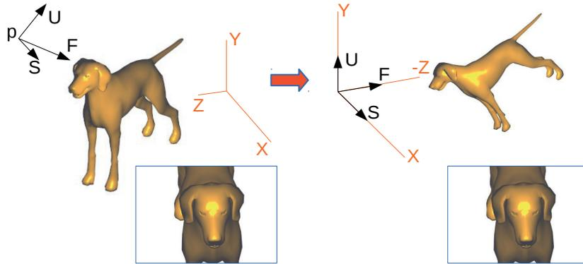
Figura 4.2: Transformación de la cámara. La cámara situada en el punto  $p$  en la imagen de la izquierda se transforma para quedar como se observa en la imagen de la derecha. Dicha transformación se aplica al objeto de tal manera que lo que se observa sea lo mismo en ambas situaciones
