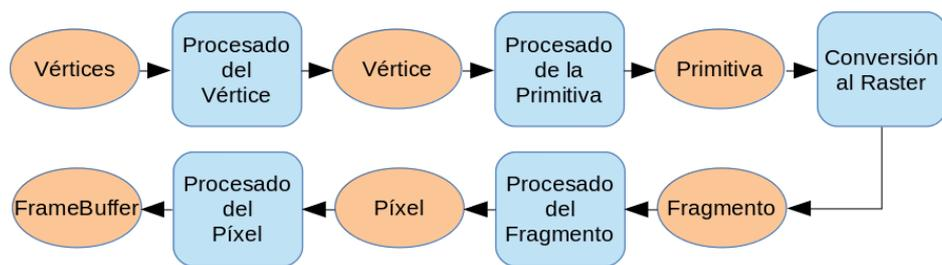
Figura 1.5: Secuencia básica de operaciones del *pipeline* de OpenGL
