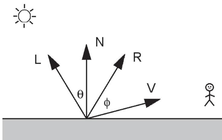
Figura 5.4: Geometría del modelo de iluminación de Phong
