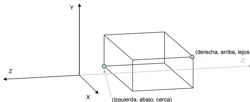
Figura 4.4: Esquema del volumen de la vista de una proyección paralela
