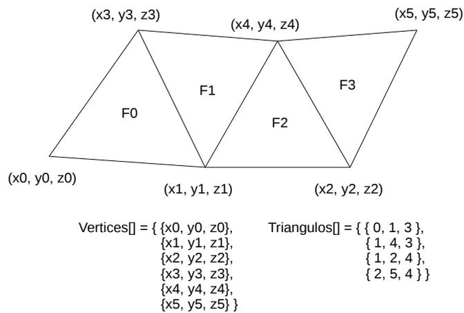
Figura 2.5: Esquema de almacenamiento de una malla poligonal mediante la estructura de vértices compartidos
