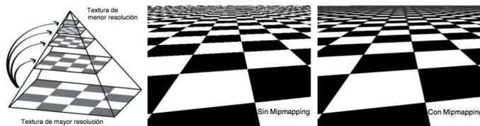
Figura 6.11: *Mipmapping* de WebGL, se construye un conjunto de texturas, cada una de ellas un cuarto más pequeña que la anterior. Observa la diferencia entre aplicar o no este tipo de filtro
