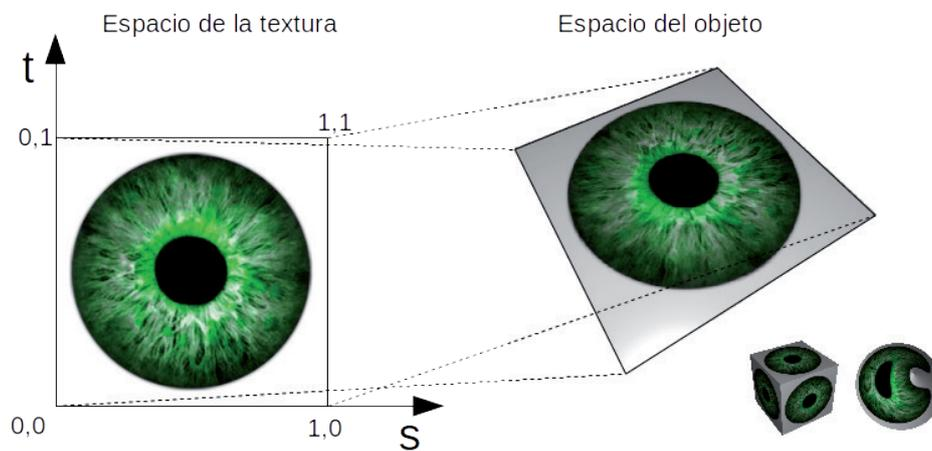
Figura 6.2: Correspondencia entre coordenadas de textura y coordenadas de un objeto
