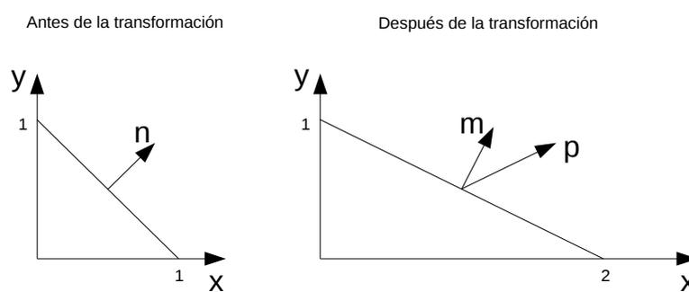
Figura 3.2: En la imagen de la izquierda se representa un polígono y su normal  $n$ . En la imagen de la derecha se muestra el mismo polígono tras aplicar una transformación de escalado no uniforme  $S(2, 1)$ . Si se aplica esta transformación a la normal  $n$ , se obtiene  $p$  como vector normal en lugar de  $m$ , que es la normal correcta
