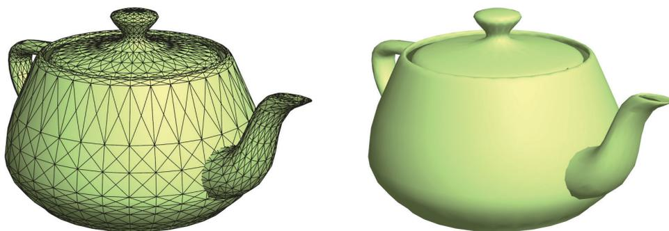
Figura 2.7: Visualización del modelo poligonal de una tetera. En la imagen de la izquierda se pueden observar los polígonos utilizados para representarla
