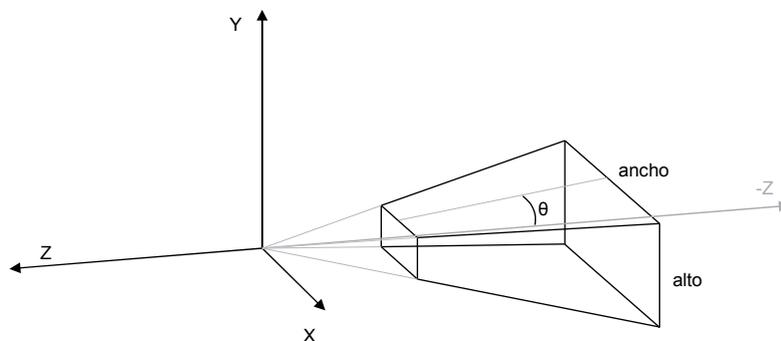
Figura 4.6: Esquema del volumen de la vista de una proyección perspectiva
