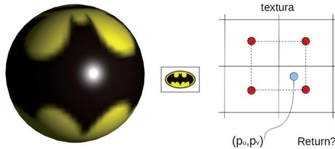
Figura 6.10: Filtro bilineal de WebGL, devuelve la interpolación lineal de cuatro téxeles y produce el efecto de borrosidad
