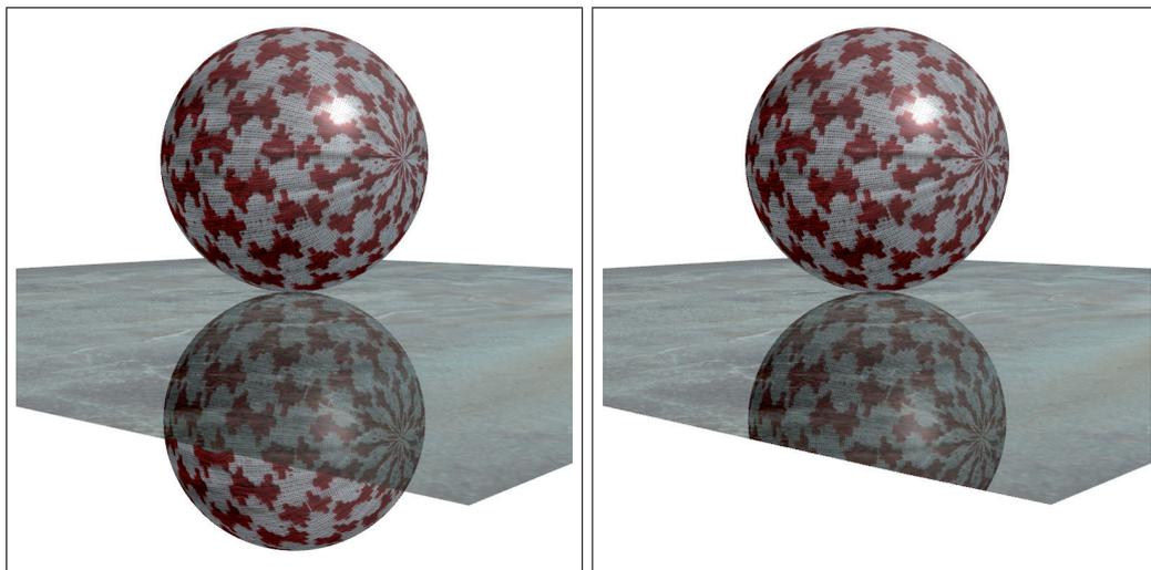
Figura 7.7: Al dibujar la escena simétrica es posible observarla fuera de los límites del objeto reflejante (izquierda). El *buffer* de plantilla se puede utilizar para resolver el problema (derecha)
