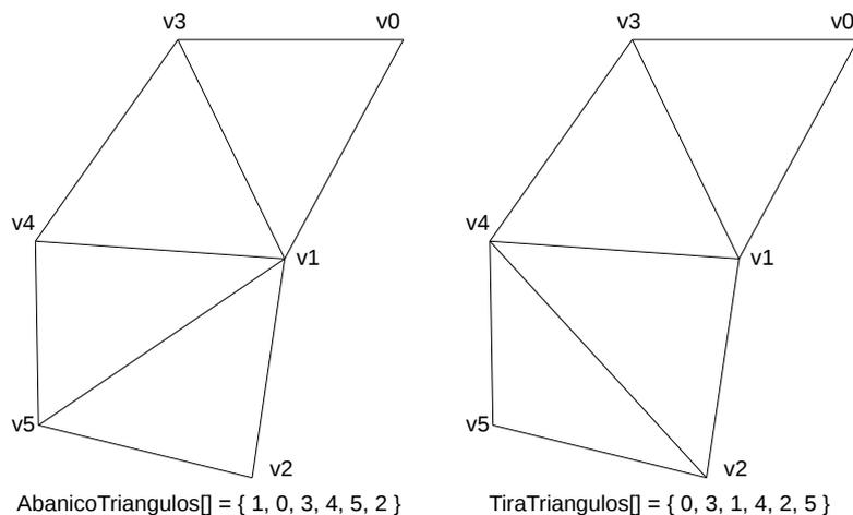
Figura 2.6: Ejemplo de abanico y tira de triángulos
