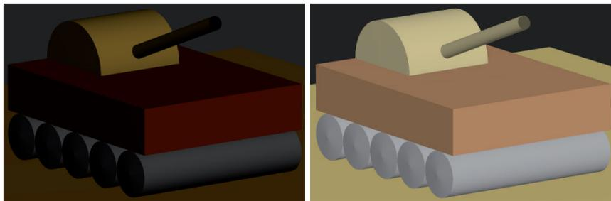
Figura 10.5: Ejemplos de corrección gamma: 1.0 (izquierda) y 2.2 (derecha)
