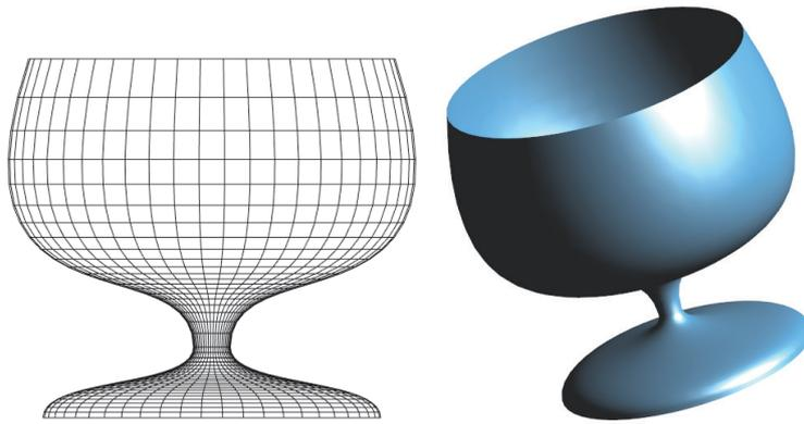
Figura 2.2: Representación poligonal de una copa y resultado de su visualización
