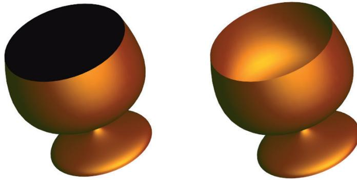
Figura 5.11: Ejemplo de modelo en el que hay que aplicar iluminación en ambas caras para una correcta visualización
