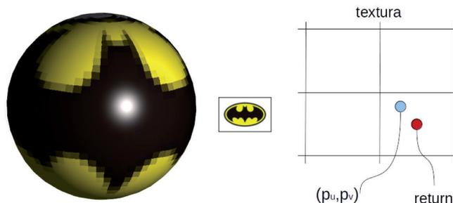
Figura 6.9: Filtro caja de WebGL, devuelve el valor del téxel más cercano y produce el efecto de pixelado
