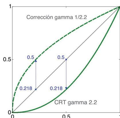
Figura 10.4: Esquema de funcionamiento de la corrección gamma
