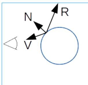
Figura 6.13: Vectores involucrados en *reflection mapping*
