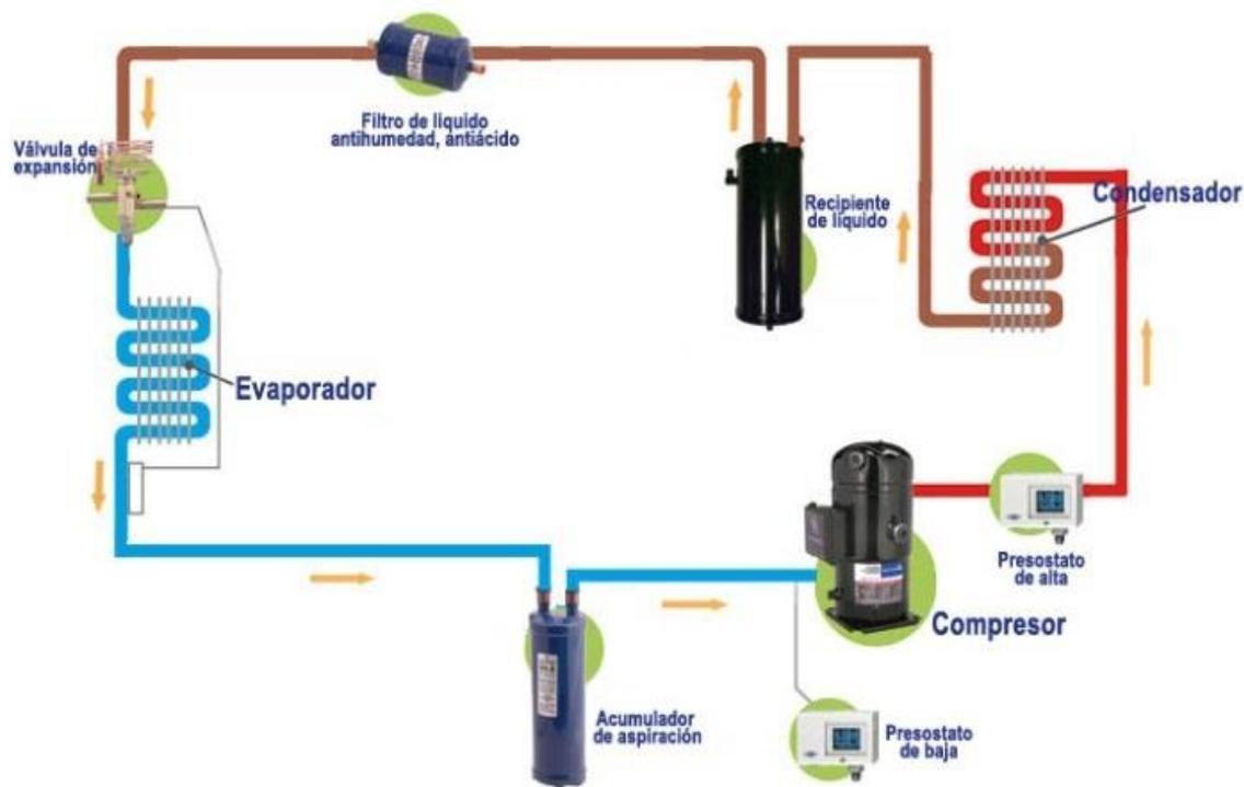
*Figura 5: Esquema de funcionamiento de un ciclo de compresión simple.*
