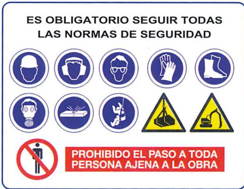
Ilustración 1: Señalización obligatoria al entrar en una obra.
