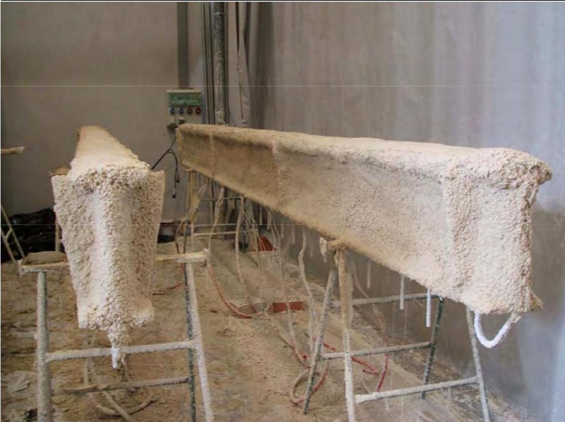
Figura 6: Protección mediante mortero proyectado
