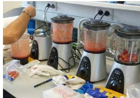
**Imagen 3.5.** Conjunto de trituradoras utilizadas para procesar la muestra y prepararla para almacenarla a  $-20\text{ }^{\circ}\text{C}$ .
