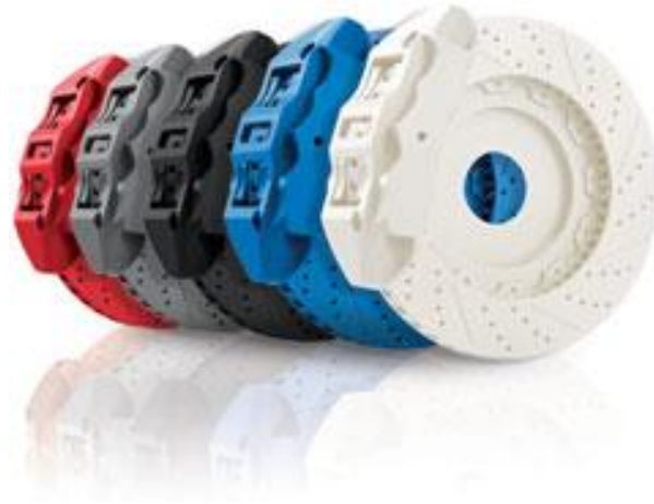
Figura 7.3. Piezas producidas a partir del modelado por deposición fundida.
