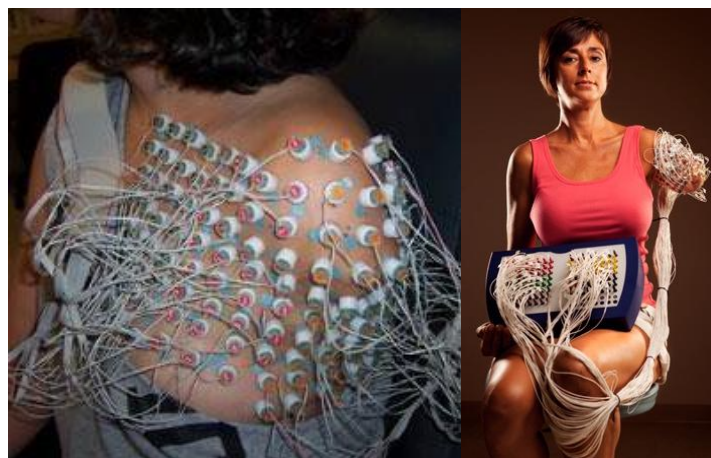
Figura 2.13. Test de electrodos, en contacto con la piel, para registrar la señal EMG.
