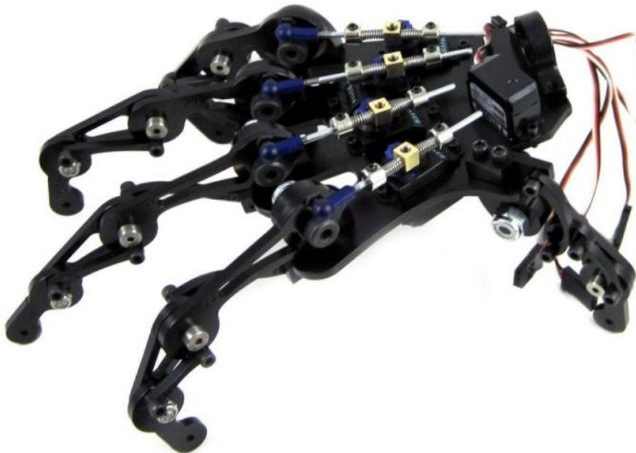
Figura 3.9. Modelo real de la MechaTE Hand usando dicho mecanismo.
