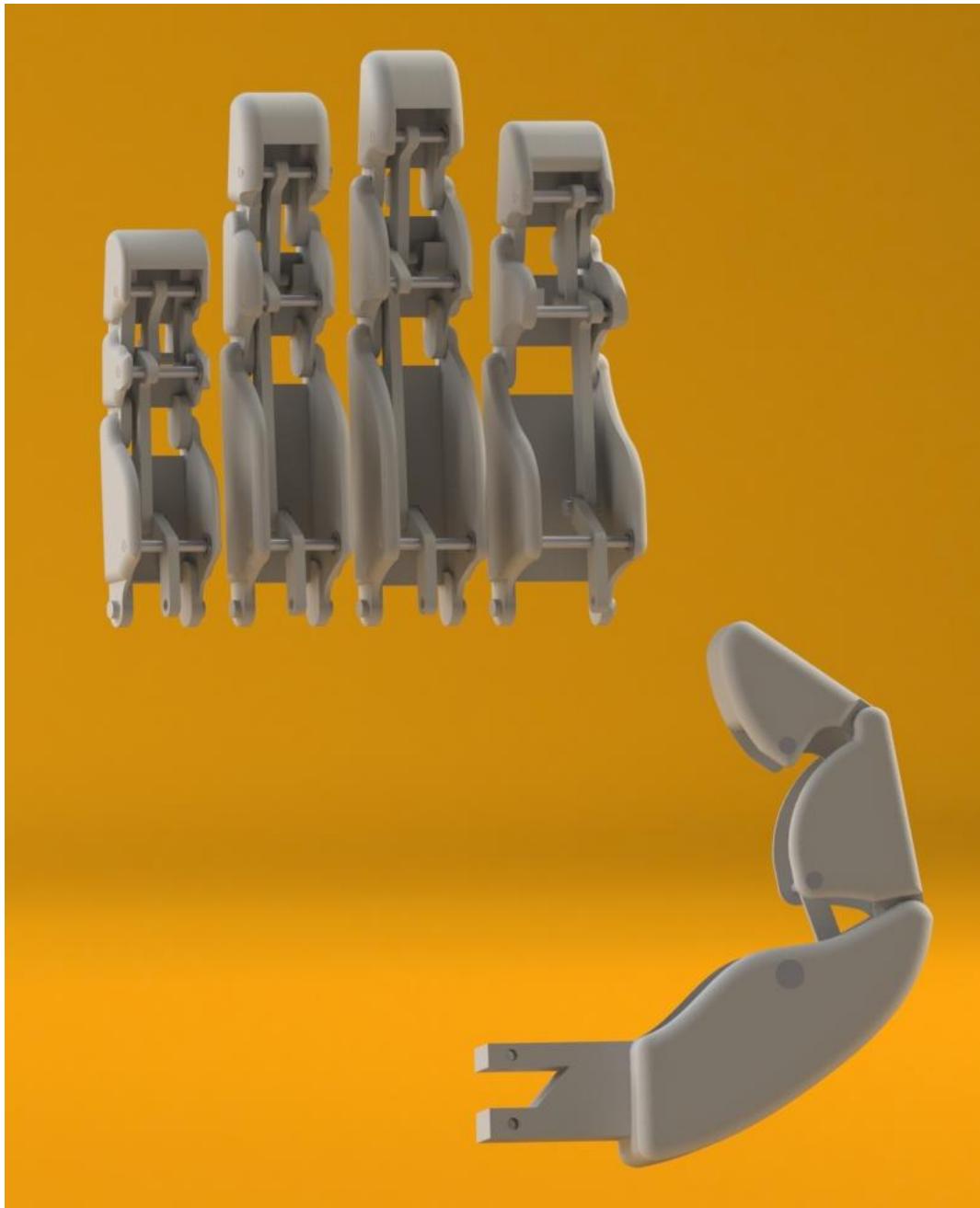
Figura 7.7. Montaje de mecanismos de 4 barras mediante los pernos.
