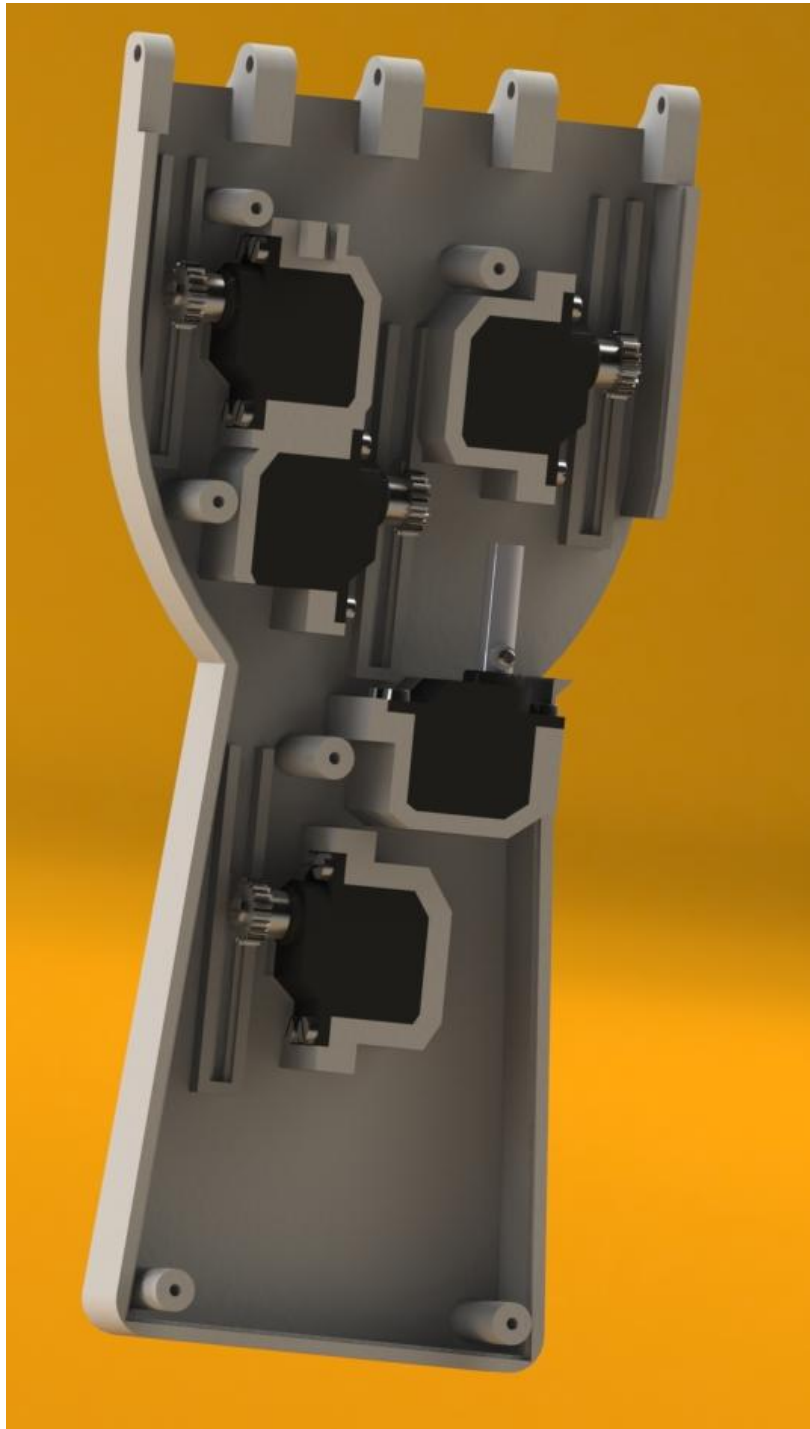
Figura 7.8. Incorporación de los servomotores en la palma de la mano.
