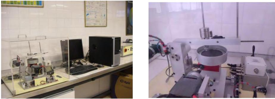
Figura 7.10. (a) tribómetro Pilint&Partners TE79/P y (b) detalle del disco del ensayo
