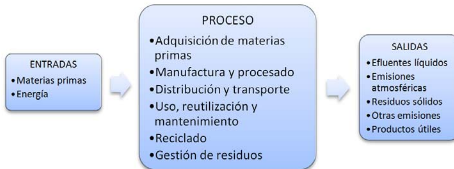
Figura 6. Esquema de la fase de análisis de inventario del ciclo de vida de un producto o proceso
