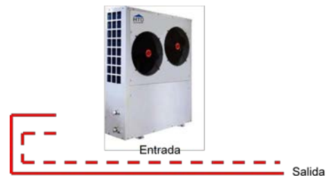
Figura 28, bomba de calor usada como equipo de calefacción
