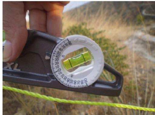
Detalle del nivel calibrado. Marca 35°
