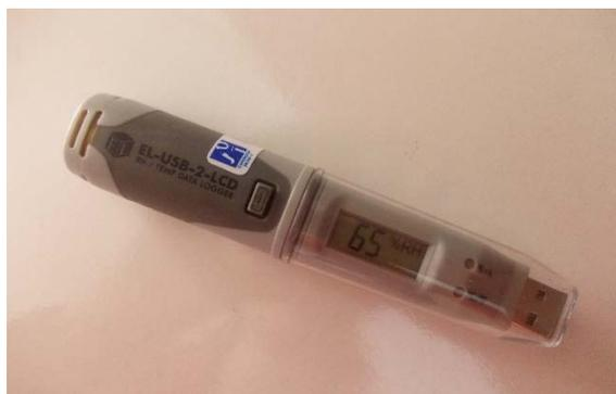
Termohigrómetro digital EL-USB-2-LCD
