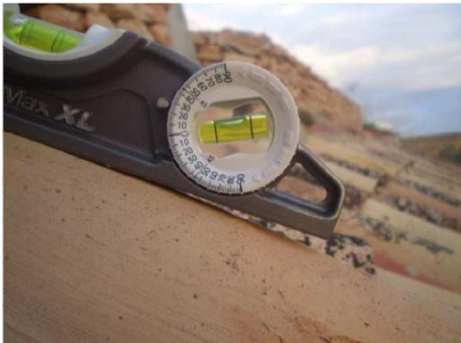
Detalle del nivel calibrado. Marca 25°
