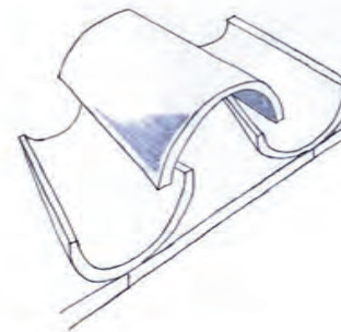
COLOCACIÓN CORRECTA DE LAS TEJAS
