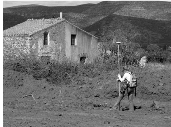
Figura 8.– Toma de datos georeferenciados de cada fragmento mediante el uso de un GPS Diferencial.
