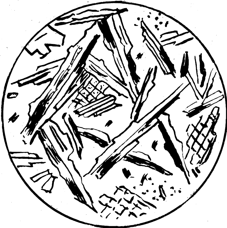
Fig. 1.- Aspecto de la estructura de una ofita vista al microscopio, N. +50 d. Dibujo simplificado fijando la atención en los minerales más desarrollados; los alargados, son plagioclasas; los reticulados, son piroxenos. Los espacios en blanco están ocupados por minerales microlíticos, no representados. (N.C. x 10).
