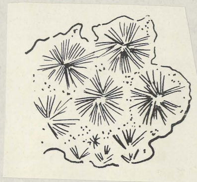
Fig. 25.— V olframita en agujas radiales formando núcleos esféricos entramados y cementados. Detalle parcial de un ejemplar que pesó 11,700 Kg. Sector sur de la Sierra de San Cristóbal. Logrosán. Cáceres.
