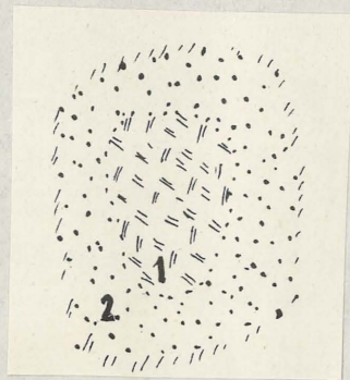
Fig. 21.—1, nódulos de casiterita cristalizada. 2, pirita arsenical recubriendo a la casiterita anterior. Todo sobre filón de cuarzo. El Berrocal. Mérida. Badajoz.
