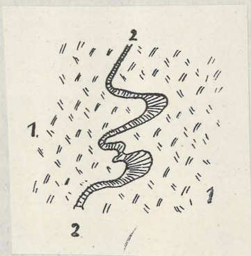
Fig. 20.—1, casiterita contenida en un filón de cuarzo. 2, arsenopirita en filoncillo ondulado atravesando a la casiterita anterior. La Periza. Montánchez. Cáceres.
