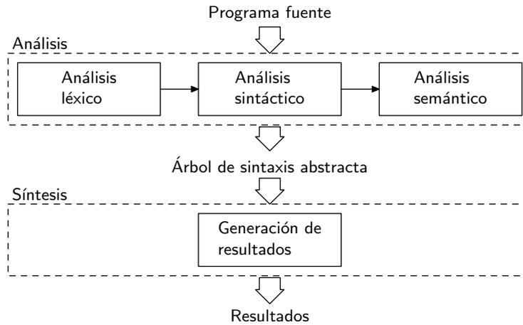
O, si utilizáramos una máquina virtual, el intérprete tendría esta estructura:
