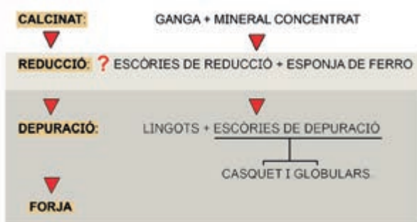
Figura 24. Cadena operativa del forn de El Castillejo.
