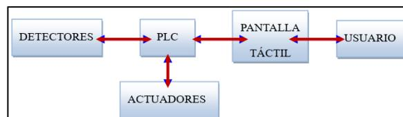
Figura 26. Esquema de la red de control. Fuente: Elaboración propia.
