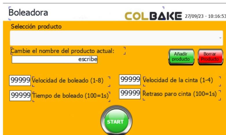
Figura 33. Diseño de la pantalla táctil. Fuente: Elaboración propia.
