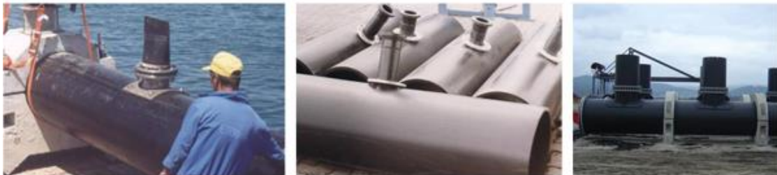
Ilustración 28: Ejemplos de emisarios submarinos con difusores
