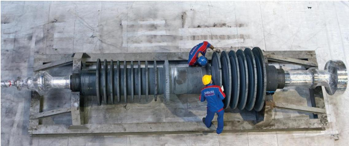
*Ilustración 8. Rotor y alabes móviles. (Ansaldo Energía, 2017)*
