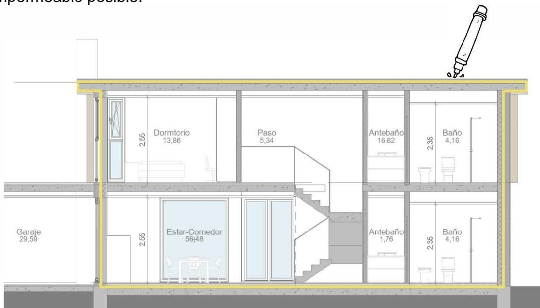
Figura 55: Aislación térmica. Fuente: Elaboración propia.
