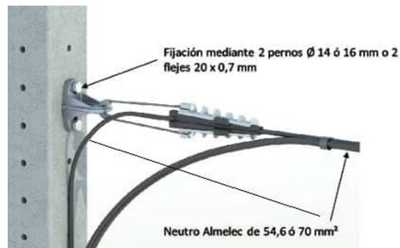
Ilustración 7. Soporte para presilla amarre (Final de línea u origen de línea)
