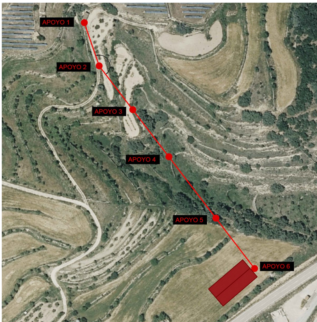
Ilustración 3. Planta línea eléctrica BT propuesta
