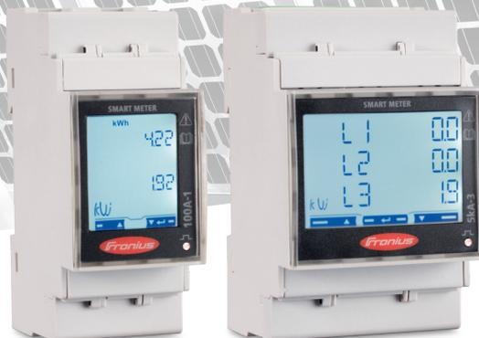
Fronius Smart Meter TS es un contador bidireccional que optimiza el autoconsumo, controla los diferentes flujos de energía y registra la curva de consumo. Gracias a la medición de alta precisión y la rápida comunicación a través del interface Modbus RTU, la limitación de potencia, cuando hay límites configurados, es más rápida y precisa que con el controlador S0.
