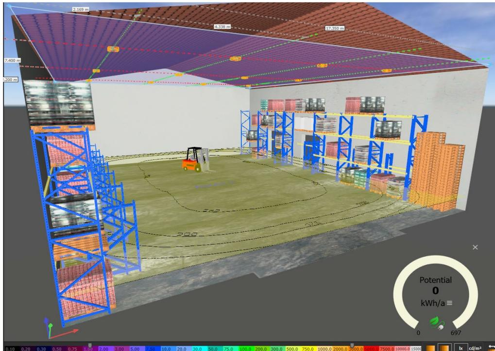
Ilustración 37: Simulación con Dialux del nivel de iluminación
