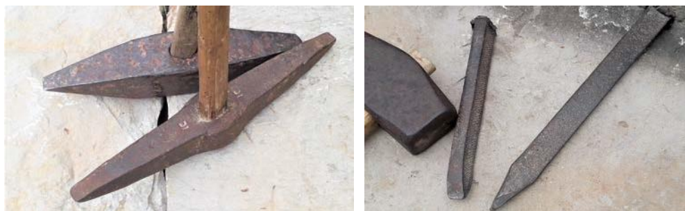
Gravadores de percussió llançada, a l'esquerra, i de percussió sostinguda, a la dreta.
