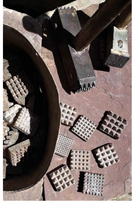
Buixardes de percussió llançada i sostinguda, a l'esquerra, i buixardes de boques intercanviables, a la dreta.
