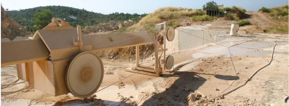
Sistema de tall amb fil diamantat en l'explotació de Canteras Bernad S.L.
