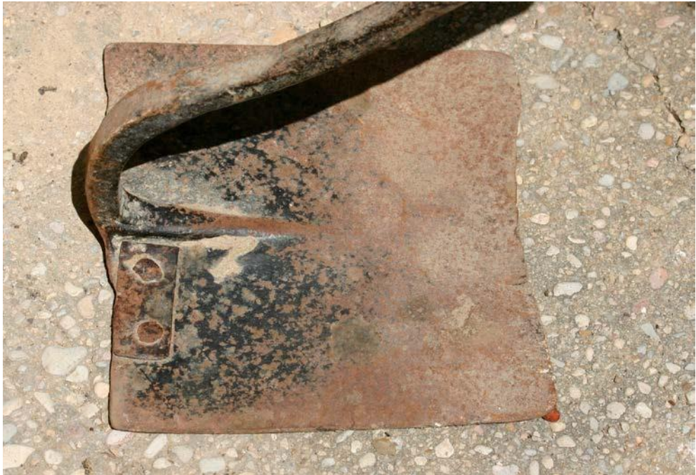
Llegona apedaçada per un manyà amb una planxeta i dos reblons.
