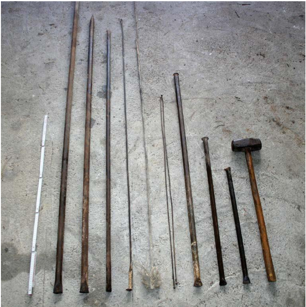
D'esquerra a dreta: barrines, culler, granereta, atacadors, pistolets i maça copla.
