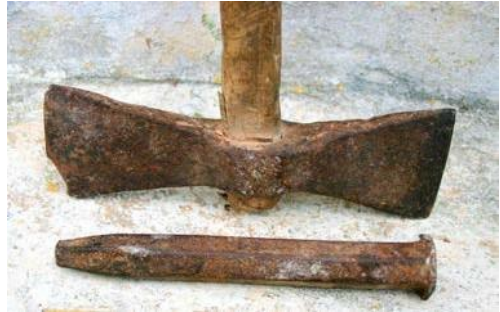
Tallant descantellat i punxó despuntat.
