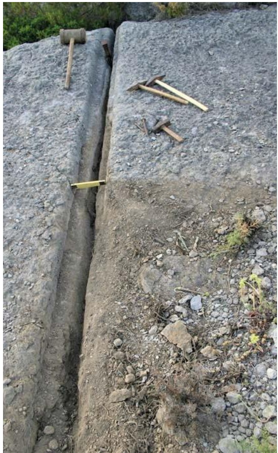
Antiga tasconera preparada per a tallar la roca a la Pedrera de dalt de La Cucala.
