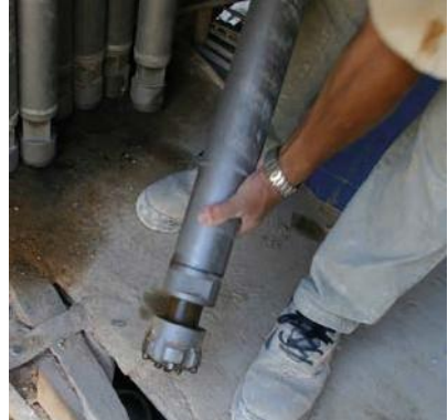
Sistema modern de broques acoblades a grans barrines per a les perforacions destinades als cables de tall, a la Pedrera de l'Abeller (Canteras Bernad S.L.).
