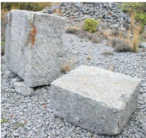
Blocs desbastats, amb les cares ratllades amb pic, a la pedrera de Sant Vicent. (4)
