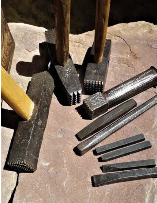
Buixardes de percussió llançada i sostinguda, a l'esquerra, i buixardes de boques intercanviables, a la dreta.
