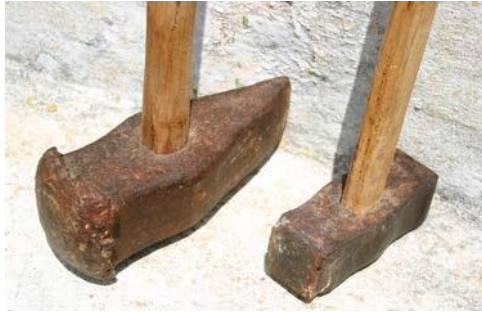
Mall rebavat i maça descantellada.
