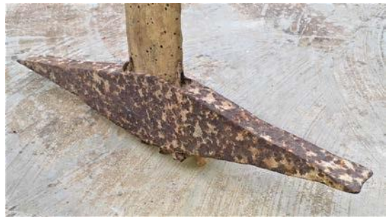
Tallant per a repicar els solcs de les moles de molí fariner.
