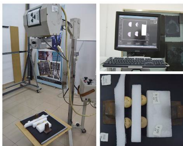
Figura 5. Preparación de las muestras y análisis de rayos X sobre las fusayolas óseas en el Laboratorio de Documentación y Registro de la UPV.
