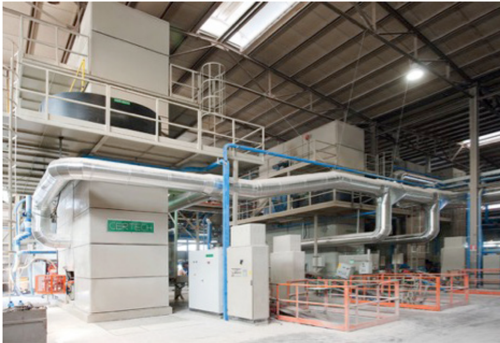
Figura 3. Secadero rápido vertical de productos cerámicos.
