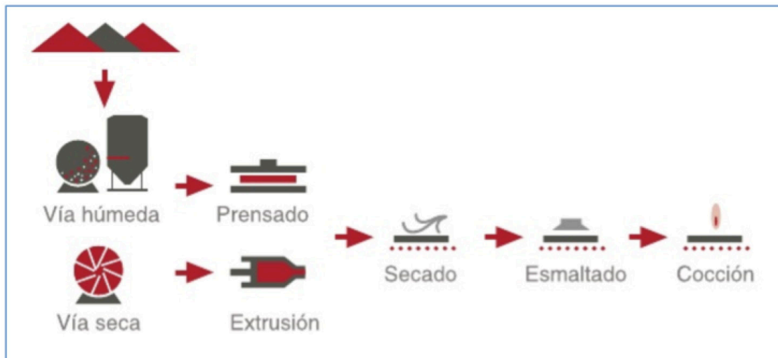
Figura 1. Proceso de fabricación de baldosas cerámicas [5].
