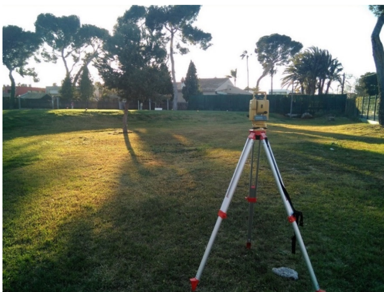
Anexo 4. Fotos del posicionamiento de la Estación Total durante las mediciones de campo
