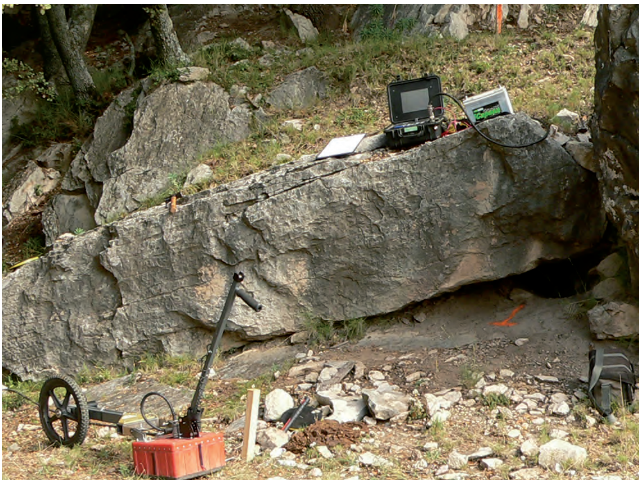
Figura 3. La imagen muestra la consola georradar donde se almacenan los datos y en la parte inferior se aprecia la antena de 400 MHz. Ésta antena está diseñada para explorar con buen detalle los primeros 3-4 metros de profundidad. El odómetro (rueda marcadora) adherido a la antena permite efectuar disparos a distancias muy precisas y su uso es obligado en los estudios 3D.
