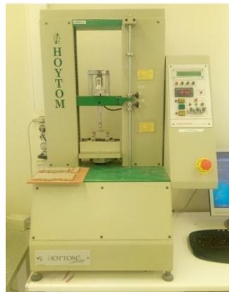
Figura 3.3.10: Ensayo de flexión a 3 puntos en maquina universal de ensayos.
