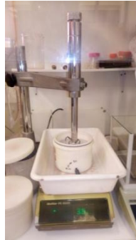
Figura 3.3.7: Montaje para determinación de densidad aparente por inmersión en mercurio
