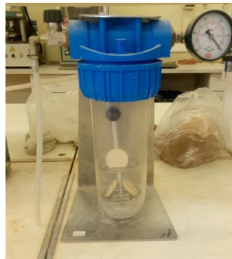
Figura 3.3.9: equipo utilizado para medir absorción de agua acoplado a bomba de vacío
