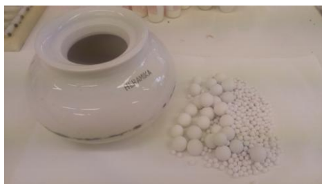
Figura 3.3.2: Jarra y bolas de alúmina usadas en molino planetario.
