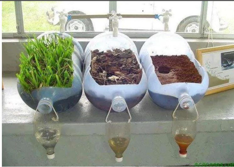
Ilustración 34: Ejemplo de garrafas convertidas en filtros: a la izquierda con césped plantado, en medio con corteza de pino y hojas y a la derecha sólo tierra.
