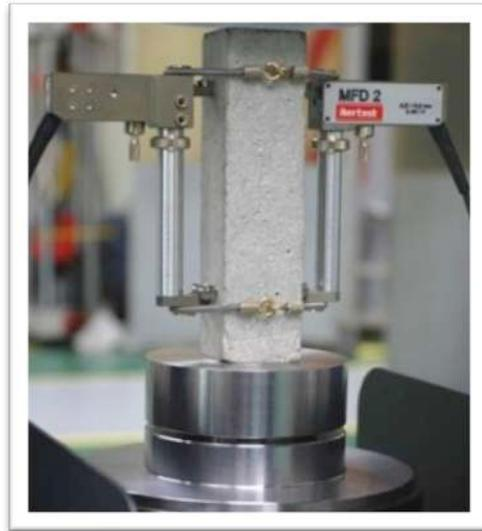
**Ilustración 76. Ensayo compresión**
