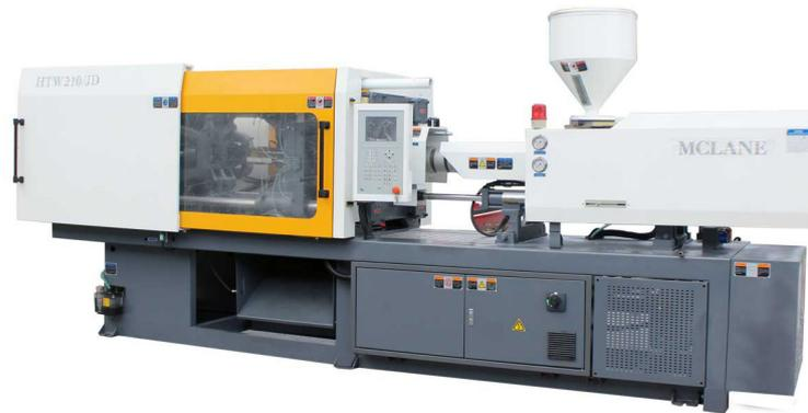
Imagen 102 (Inyectora )
