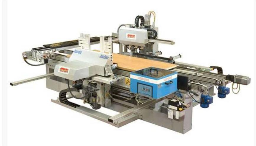
*Imagen 6: Máquina insertadora/atornilladora de herrajes en las puertas*
