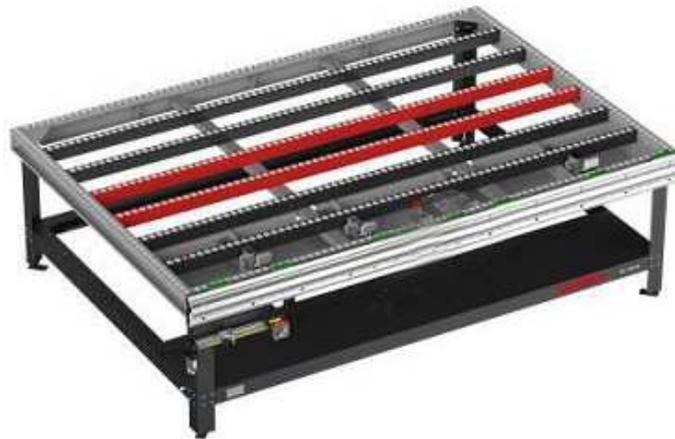
*Imagen 7: Banco de montaje con cinta transportadora*
