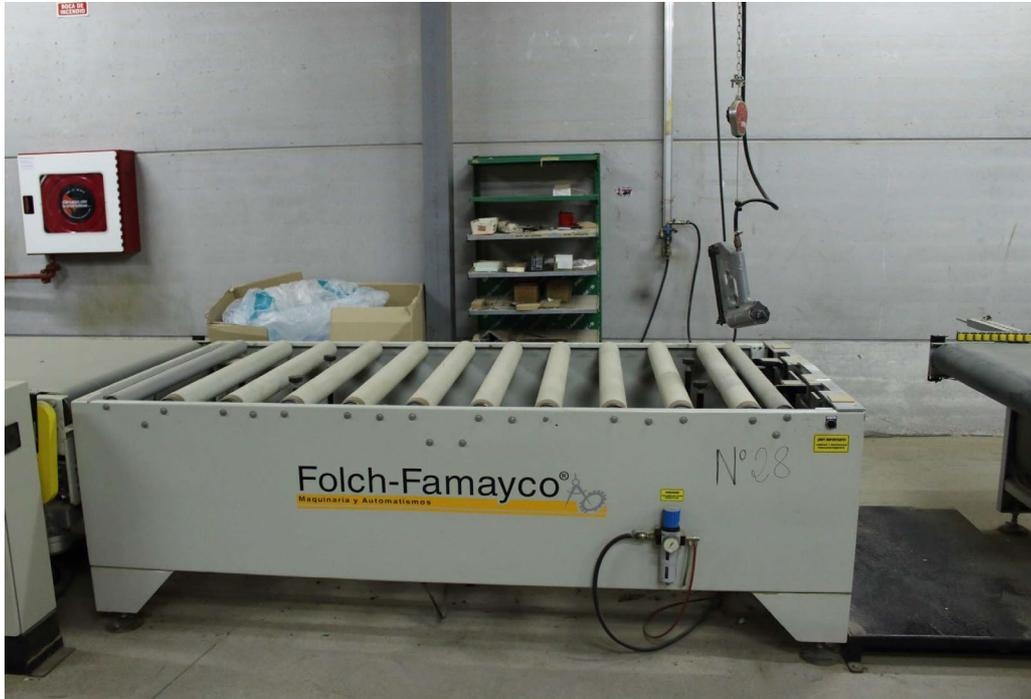
Imagen 21: Banco de montaje para puertas block BMA-2200
