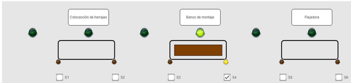
Imagen 32: Muestra en pantalla de la localización de la puerta, el estado de los sensores y las "tick-boxes"
