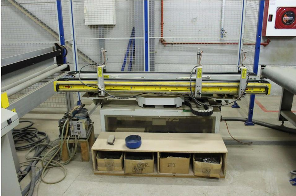
Imagen 19: Máquina para la colocación de pernos y cerradura Mod PC-4
