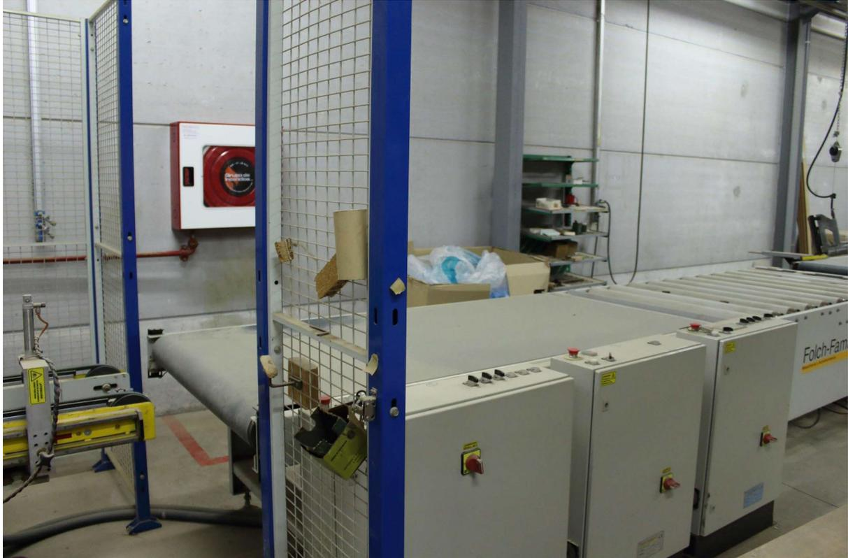
*Imagen 20: Cinta transportadora de aceleración*
