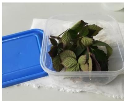
**Figura 10.** Colocación de la muestra en el recipiente en el que posteriormente se añadirán los 500 ml de etanol. (Fuente propia)
