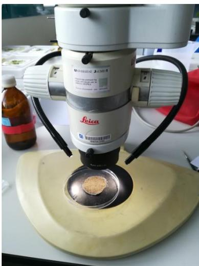
**Figura 18.** Lectura de la muestra sedimentada en la membrana mediante la lupa binocular. (Fuente propia)
