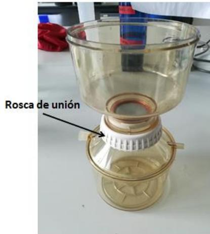
**Figura 15.** Acople de la parte superior al resto del aparato mediante una unión roscada. (Fuente propia)
