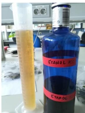
**Figura 9.** Medición de los 500 ml de etanol diluido al 70% necesarios para sumergir la muestra. (Fuente propia)
