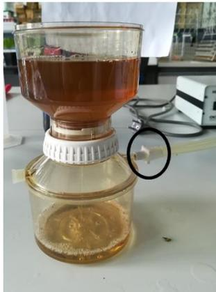
**Figura 13.** Unión del tubo de la bomba de vacío al filtro de vacío. Filtro de vacío en funcionamiento filtrando el etanol a la parte inferior. (Fuente propia)
