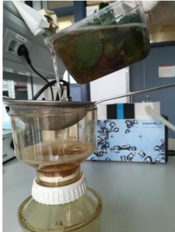
**Figura 11.** Prefiltrado de la muestra con la ayuda de un colador con el fin de que lo que se avoque al aparato sea únicamente el resultado de la dilución de la muestra de mora y se desechen los restos vegetales que se queden en el colador. (Fuente propia)
