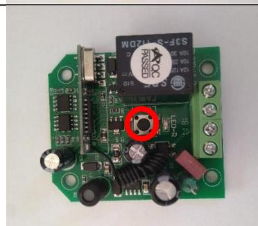
5. Volver a presionar dicho botón durante 3 segundos hasta que el indicador rojo se encienda. Presionar dos veces el botón del mando. El indicador del receptor se debe apagar. Con ello, hemos emparejado los dispositivos.
