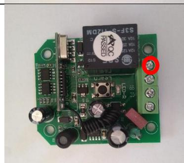
4. Una vez conectado el receptor podemos poner las pilas en el juguete. A continuación, presionar el botón del receptor durante 10 segundos hasta que el indicador de señal se ilumine y luego se apague. Así, conseguimos eliminar cualquier código anterior del receptor.
