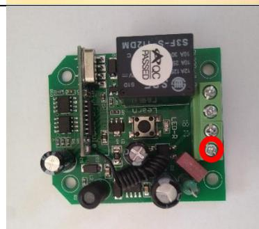
3. En el canal de salida conectaremos el cable que conduzca hacia el dispositivo que queremos conectar.\*
