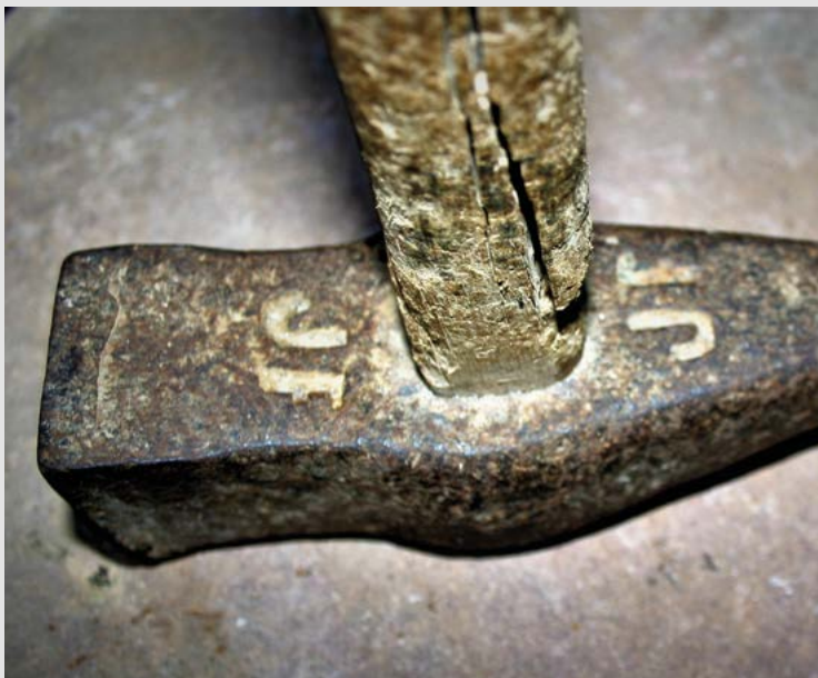
Martell de Jaume Falomir, pedrapiquer de Borriol, marcat amb les inicials per a acreditar la propietat, utilitzat a les obres de Barcelona
