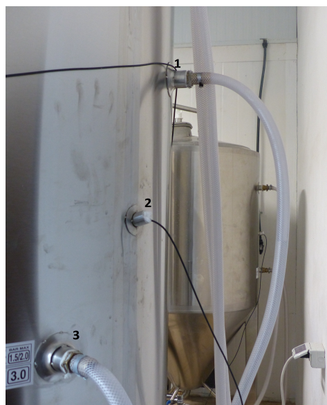
Imagen 31– Conexiones líquido refrigerante y sensor temperatura
